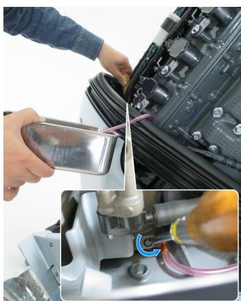
5. ベーパーセパレーターのドレンスクリューをゆるめます。ドレンチューブから燃料が流れ出したら燃料が出終わるまでチルトアップの状態にして待ちます。
